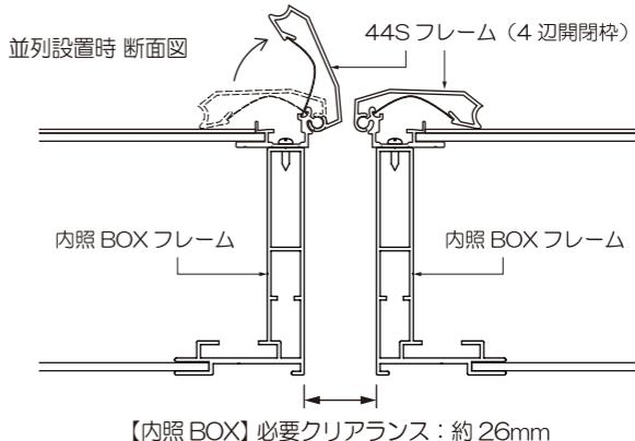
2台の製品を並列設置する際、内照 BOX 同士の間は26mm以上の間隔をあけて設置してください。内照 BOX 間で26mmの間隔を設けた時、正面ポスターグリップフレームの間は約10mmになります。正面からみて最低10mm以上の間隔があいていれば、フレームを片側ずつ開閉することができます。
