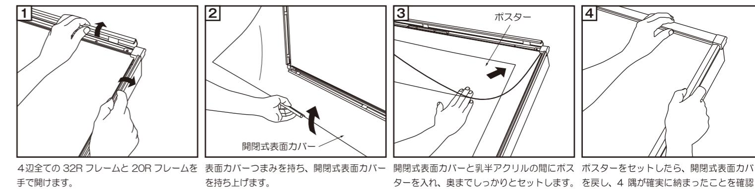
4辺全ての32Rフレームと20Rフレームを表面カバーフックを持ち、開閉式表面カバーを持ち上げます。開閉式表面カバーとラバーアクリルの間にボスをセットしたら、開閉式表面カバーを奥までしっかりとセットします。ポスターをセットした後、4隅が確実に納まったことを確認し(ポスターはバックライトフィルム推奨です)4辺フレームを閉めて完了です。
