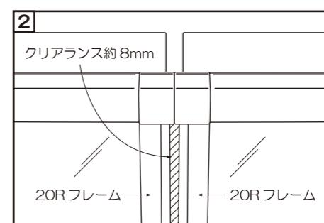
コーナーピースを合わせると、左右開閉枠(20Rフレーム)の間、斜線部には約8mmのクリアランスが残ります。
