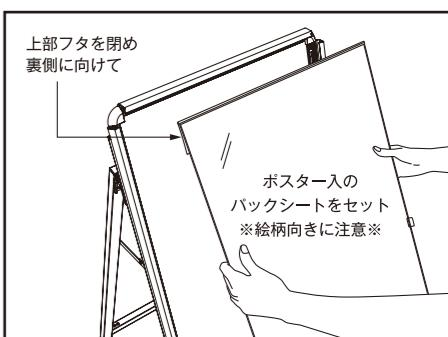
袋の硬い透明板側に絵柄が向くようにポスターを入れ、上部フタを開めて袋ごとパネルに再度セットしてご使用ください。ポスターとフレームの間に隙間ができ導光板が露出する場合はポスター位置を調整してください。
