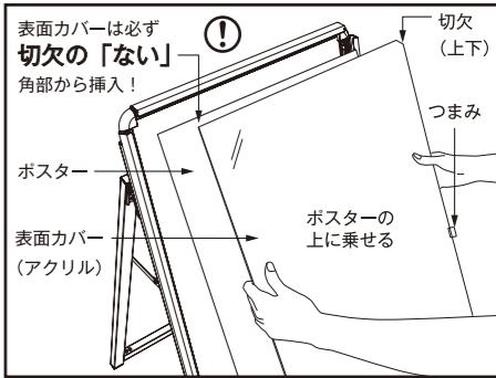
ボスターを本体にセットし、その上に表面カバーを乗せ、フレームを閉じてセット完了です。表面カバーは表裏の保護シートを剥がしてご使用ください。
