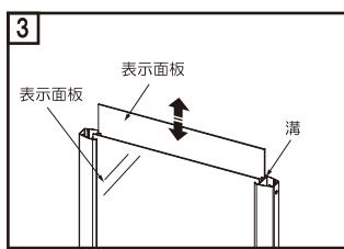
フレームの溝にセットされている表示面板を引き抜きます。印刷等をされてから再度溝に差し込み、フレームとコーナーピースを戻してセット完了です。
