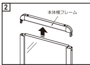
ビスを外したら、上部の本体横フレームとビスで固定されたコーナーピース2ヶのセットを引き抜いて外します。
