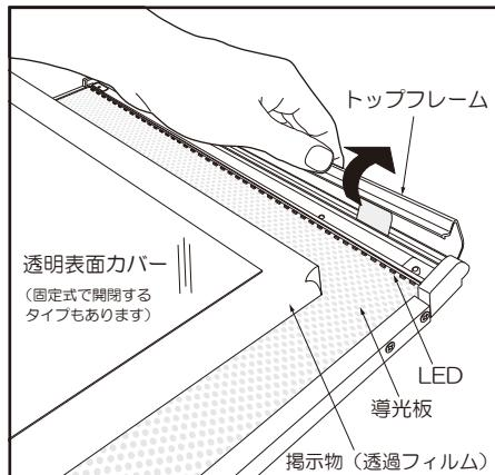
上下のフレームを手で開きます。表面カバーがセットされているので外してから（仕様によって、固定式のものもあります）掲示物（バックライトフィルム）を導光板の上にセットし、表面カバーを上からセット後フレームを閉じて完了です。
